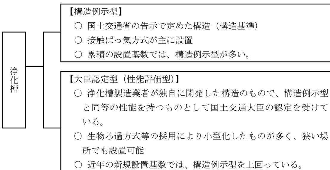
浄化槽の技術的な進歩はめざましく、現在では多種多様な浄化槽が開発され、生活排水対策の目的に応じて選択ができるようになっている。
