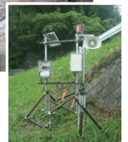
中川村陣馬形谷田川 土石流の発生と応急対策 （土石流センサ及び警報器の設置）
