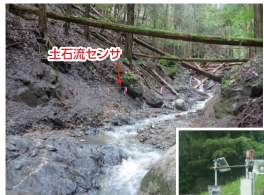
中川村陣馬形谷田川 土石流の発生と応急対策 （土石流センサ及び警報器の設置）
