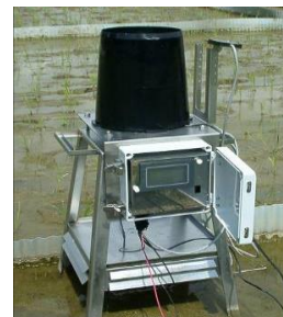
“农作物导航仪” 通过农作物生长发育的 诊断装置进行种植管理
