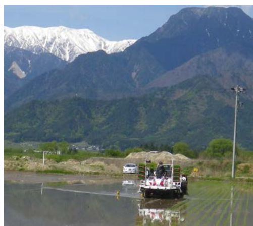
スマート農業田植機（地力データに基づき施肥量を自動制御）（池田町）
