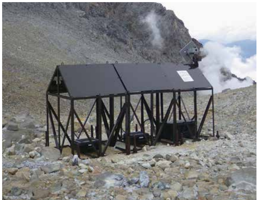
気象庁が八丁ダルミに設置した火山ガス観測装置（気）
