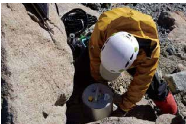
平成29年10月17日、剣ヶ峰下に地震計を設置している様子（名大）
