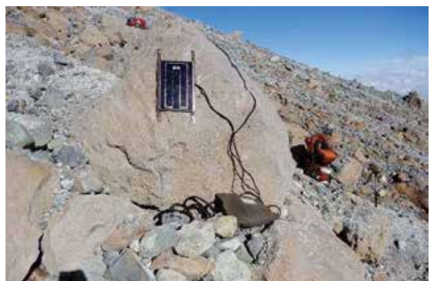
地震計の設置完了後。周りには風よけのため石を積んでいる（名大）
