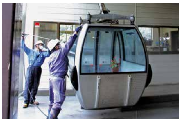
火山灰は放置すると固まるので早急な洗浄が必要だった（中邑）
